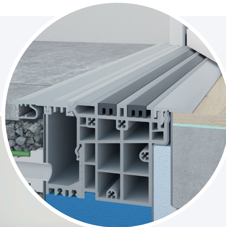
Abbildung: Beide Magnetprofile senken sich beim Öffnen der Tür ab.
